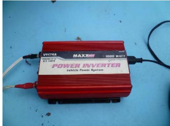
Fotografía N° 8: Convertidor de energía de 12vol. A 110 Vol.
